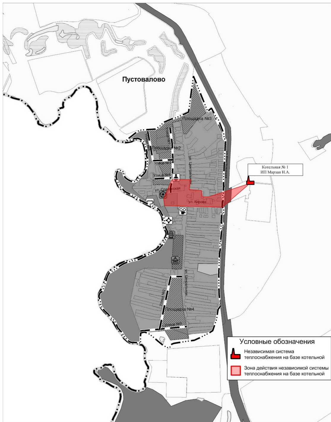
Рисунок 1.12.5.2 - Источники тепловой энергии с. Пустовалово
